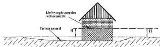
▪ **En cas de terrassements en déblais,** la hauteur doit être mesurée par rapport au terrain naturel initial
