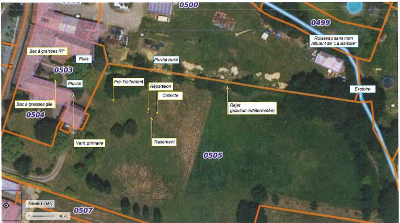
Schéma de principe des éléments contrôlés ou déclarés lors de la visite de 2021 Schéma sans échelle
