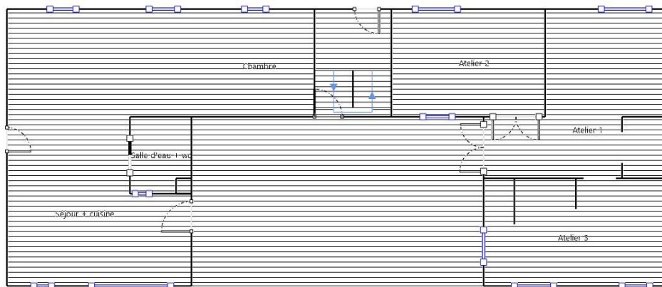
M001 - Plaques (fibres-ciment) Présence d'amiante EP
