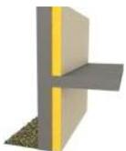
**Ajout d'une isolation thermique par l'intérieur des murs mitoyens : 130 mm de polystyrène expansé + doublage intérieur - R = 3.6 m<sup>2</sup>.K/W - Surface isolée = 23 m<sup>2</sup>**
