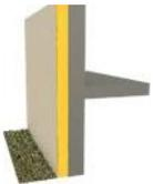
**Ajout d'une isolation thermique par l'extérieur sous enduit : 130 mm de polystyrène expansé + enduit de façade - R = 3.7 m<sup>2</sup>.K/W - Surface isolée = 164 m<sup>2</sup>**
