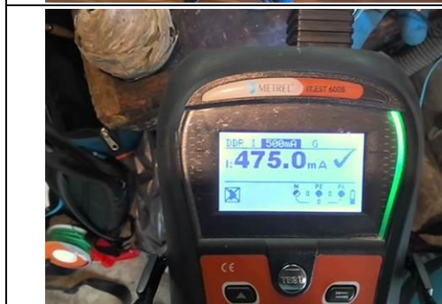
Photo n° PhEle008 AGCP 500 mA déclenche avant son seuil maximum
