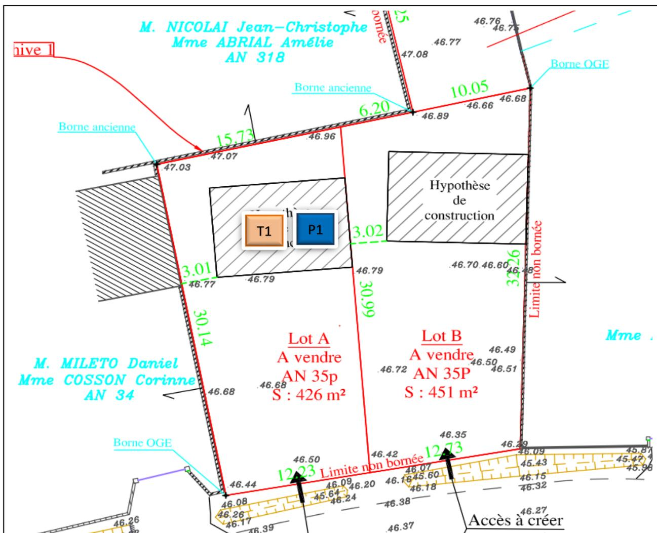
Sondage pénétromètre dynamique : P1
